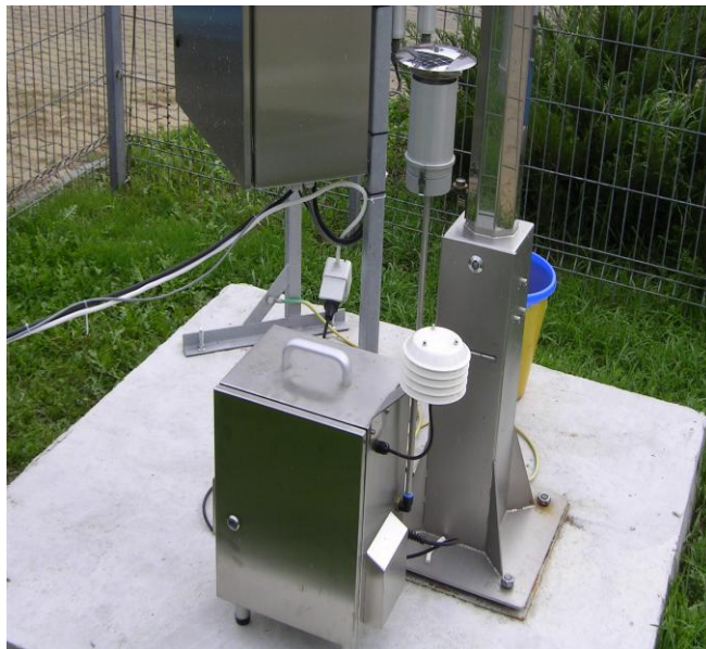
Figura nr. 2.3.1. Sistem prelevare particule in suspensie LVS3 utilizat la determinarea PM 10
