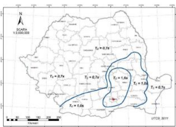
Figura 9 – Zonarea teritoriului Romaniei in termeni de perioada de control T_c a spectrului de raspuns
