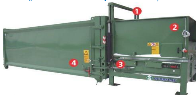
Figura 7-6 Sistem de compactare fix al deșeurilor
