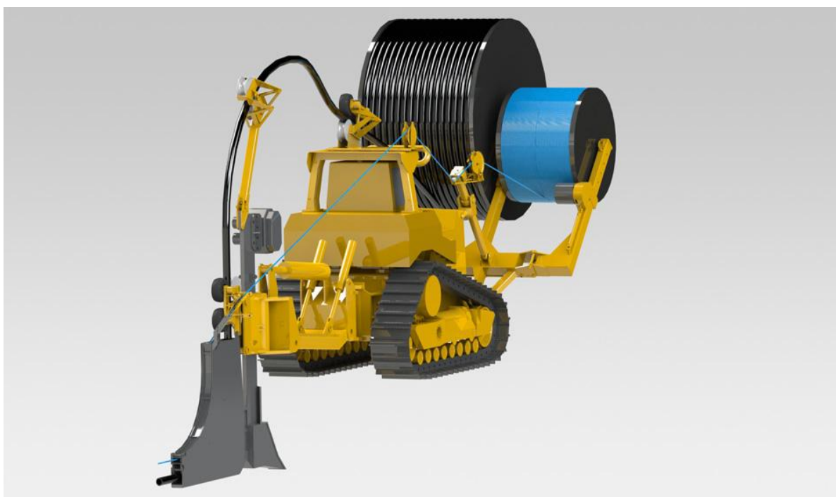
Figura nr. 2 - Montarea fibrei optice prin tub de protecție, prevăzut cu bandă de avertizare
